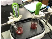
【物質の粘性の差による温度変化の比較実験】
