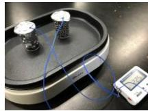
【鉄球の大きさの違いによる温度変化の比較実験】
