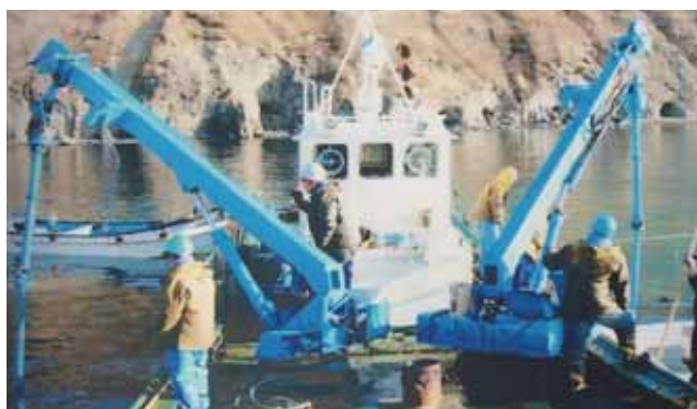
図6-1 SKフープ工法による雑海藻駆除作業 (出典:『雑草駆除 SKフープ工法(スパイラル&クランク フープ工法)』(㈲カネ亥 松井商会)より)
